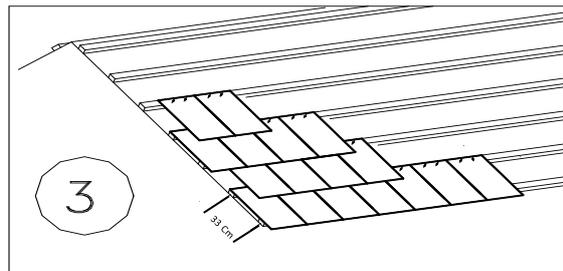
Nervios (listones para instalar sobre el techo impermeabilizado)
